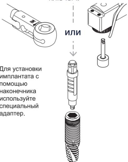
Для установки имплантата с помощью наконечника используйте специальный адаптер.
