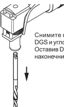
Снимите короткое сверло с DGS и углового наконечника. Оставив DGS в угловом наконечнике.
