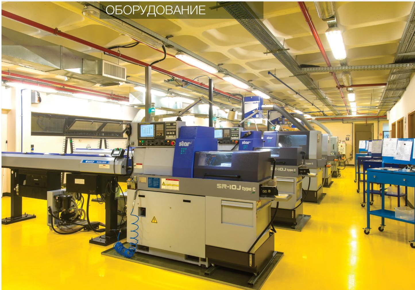
Заготовки превосходного титанового сплава Grade 5 превращаются в высококачественные зубные имплантаты и протетические компоненты на современном оборудовании с программным управлением.
